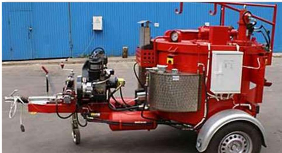
Прицепные мастичные заливщики швов **135М-3** предназначены для плавления, поддержания в разогретом виде, транспортировки и раздачи мастики в ручные заливщики.
