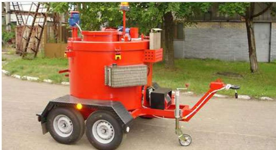
Битумозаливщик **ЭД-235М** предназначен для приема, поддержания рабочей температуры и подачи битума и битумных эмульсий в швы и трещины дорожных покрытий, а также грунтовки карт при ямочном ремонте. Состоит из рамы с одноосной мягкой подвеской, термоизолированной емкости, горелки, битумного насоса, термометра, гидрораспределителя. Привод битумного насоса – от гидросистемы трактора типа МТЗ-80, 82.
