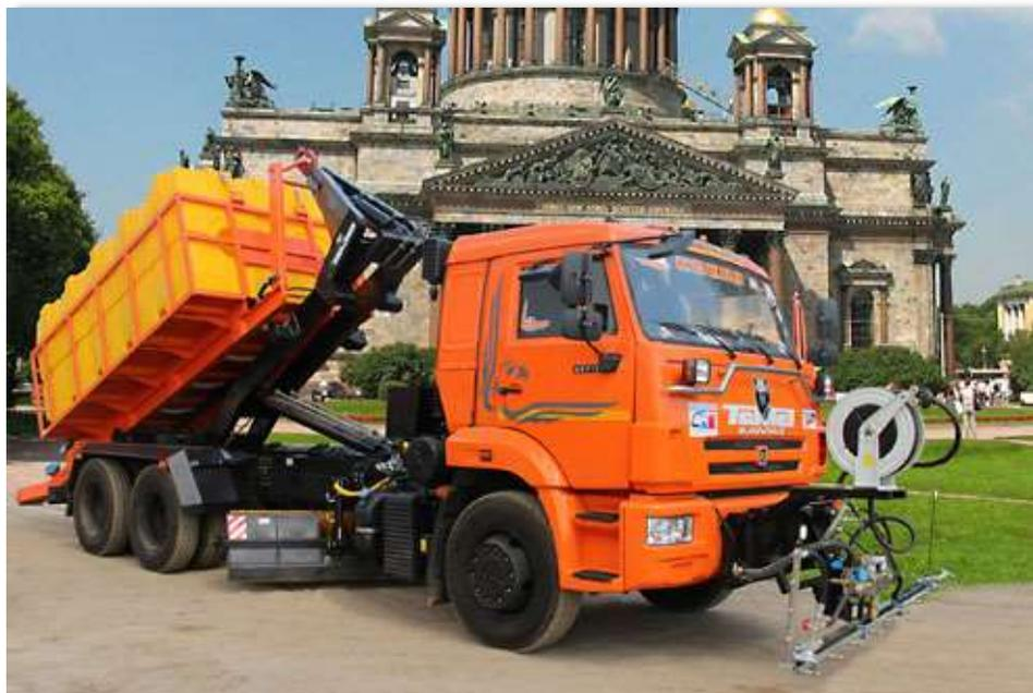
Машина комбинированная дорожная уборочная **СОКОЛ** на базе шасси **КамАЗ 65115**.
