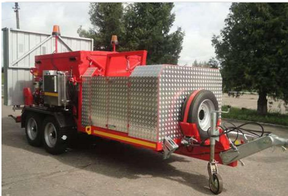
Ремонтер дорожный ЭД-105М предназначен для ремонта асфальтобетонного дорожного покрытия, методом разогрева асфальта инфракрасным излучением до подвижного состояния и формирования заплатки с частичным добавлением свежей асфальтобетонной смеси.
