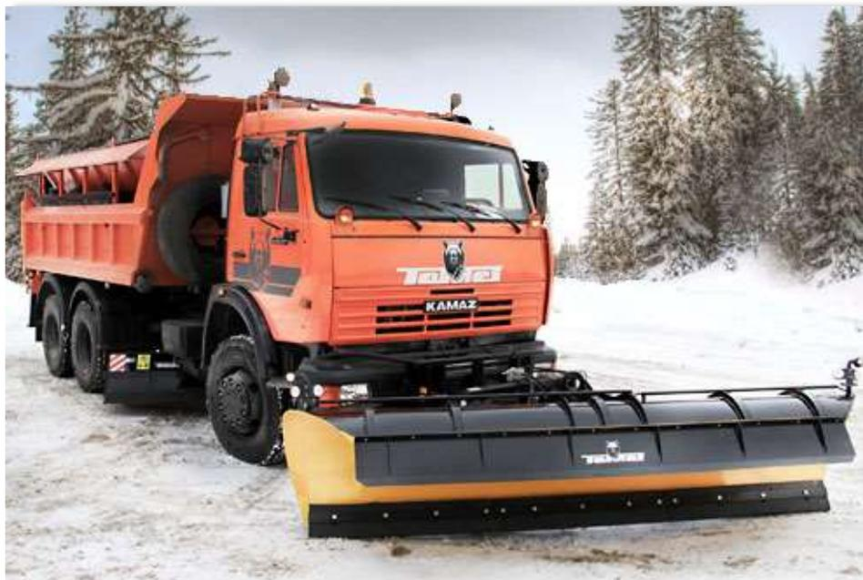
ОАО «Тосненский механический завод» выпускает машину комбинированную дорожную уборочную **МКДУ-1** на самосвальном шасси **КАМАЗ-65115** предназначенную для всесезонного содержания автомобильных дорог, транспортировки и самосвальной разгрузки сыпучих материалов.
