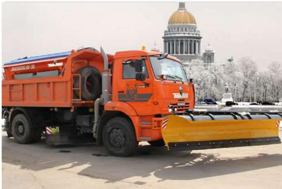
МКДУ-10 на базе автомобиля КАМАЗ-53605 (шасси экологического класса Евро-3), предназначена для всесезонного содержания автомобильных дорог. Машина полностью гидрофицирована.
