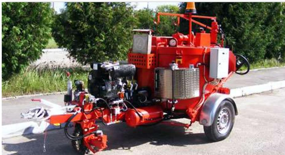
Самоходные мастичные заливщики швов **135М-2** предназначены для плавления, поддержания в разогретом виде, транспортировки и раздачи мастики в ручные заливщики.
