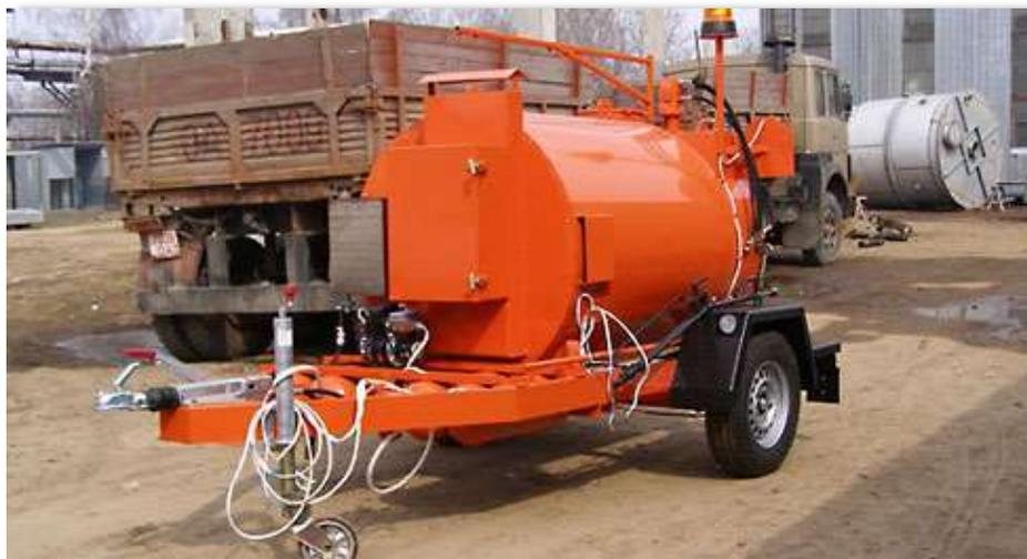
Ручной заливщик предназначен для разогрева битумной мастики и ее последующей заливки. Данный заливщик предназначен для работы на небольших территориях. В отличие от аналогов, оснащенных щитом - дном для защиты от прямого пламени горелки, заливщик **ЭД-3М** имеет масляную рубашку, чтобы пламя горелки не перегрело мастику и она не потеряла свои свойства.
