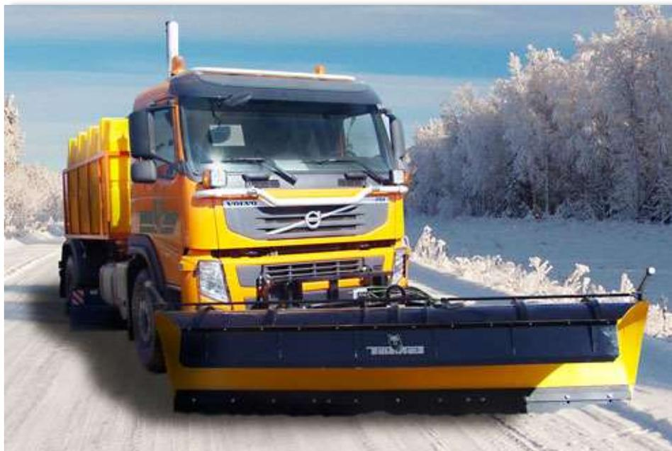
Дорожная комбинированная машина **МКДУ-8** изготавливается как на шасси, так и в самосвальном исполнении на базе автомобиля **Volvo FM/FH**.
